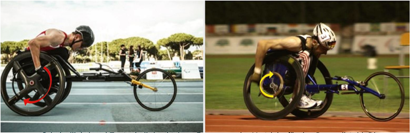
Abb. 5.54 Schub- (links) und Zugtechnik (rechts) zur Erzeugung des Vortriebs für den Rennrollstuhl. Die Schulterachse befindet sich jeweils vor dem Greifreifen (Strobel)
