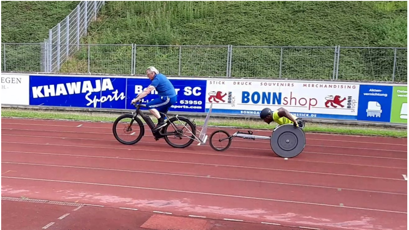
Abb. 5.60 Intervalltraining mit Steher-E-Bike (links) bei vorgegebenem Plastikschild am Hinterrad zum Windschutz
