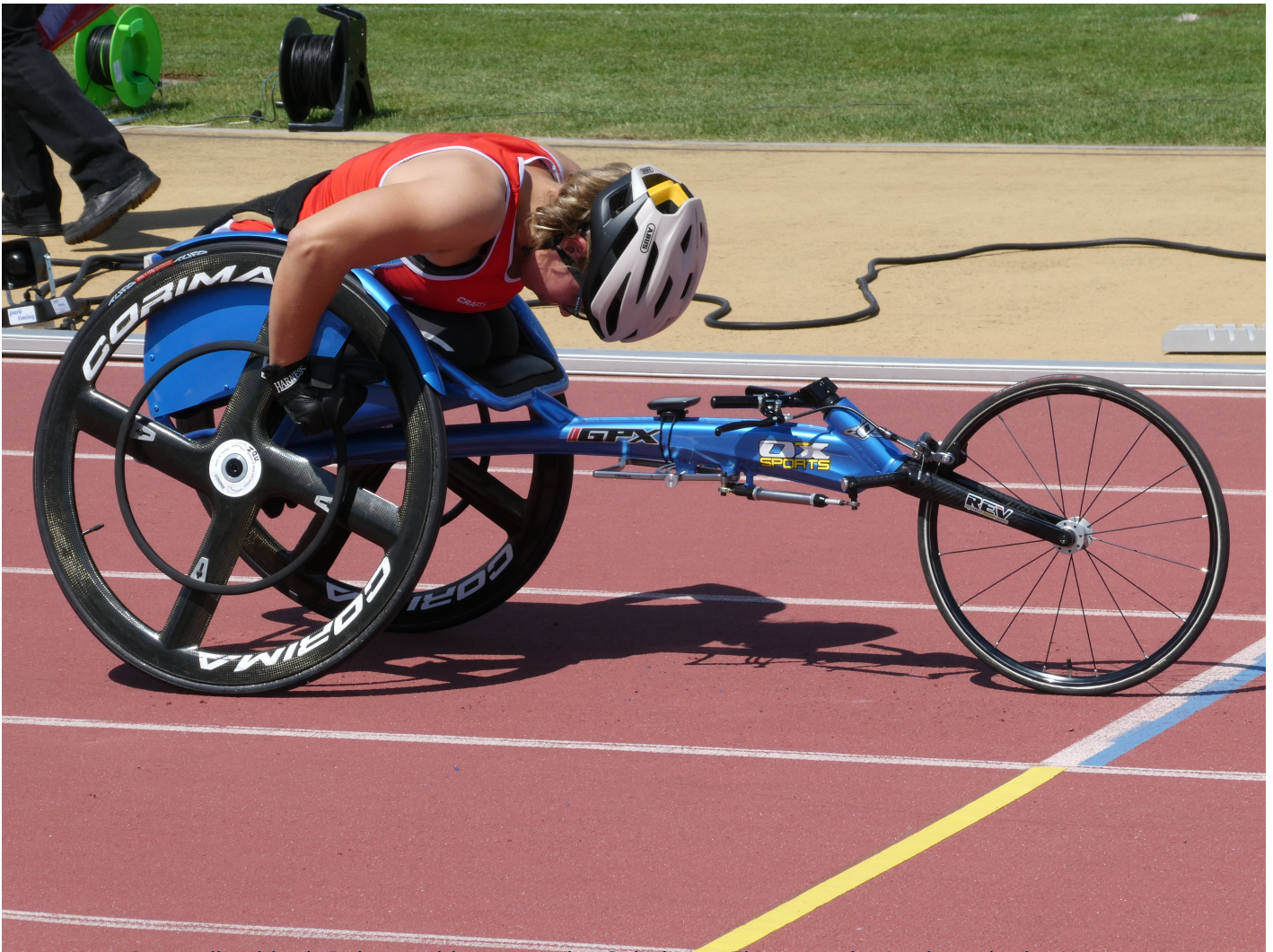
Abb. 3.21 Rennrollstuhl mit Bahnanschlag unter der Gabel zum Einrasten der Lenkung in der Kurve
