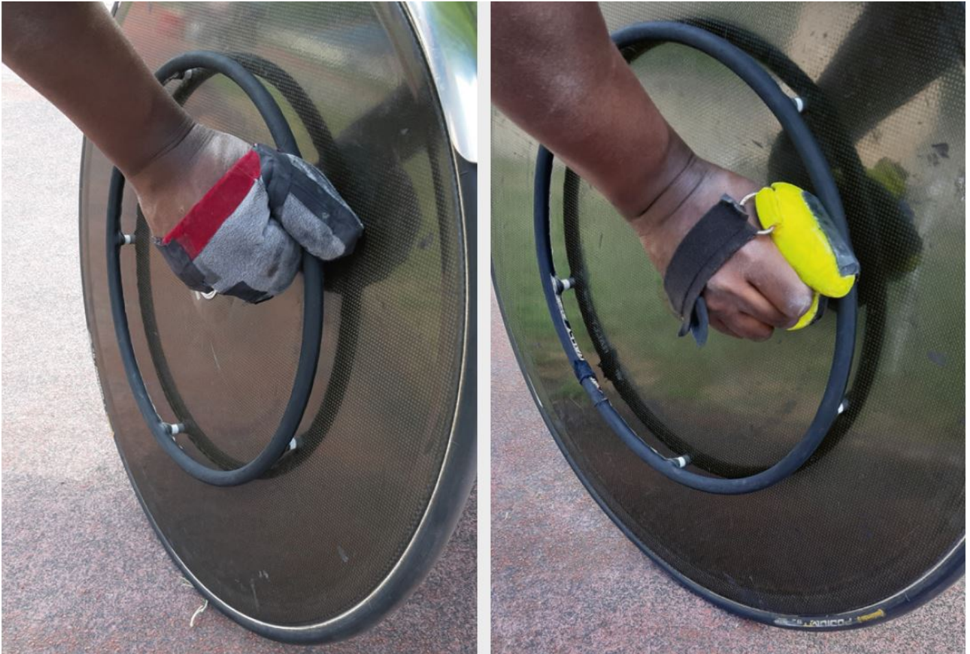
Abb. 3.20 Feste Handschuhe (links) und Schalenhandschuhe für den Antrieb des Renn-Rollstuhls
