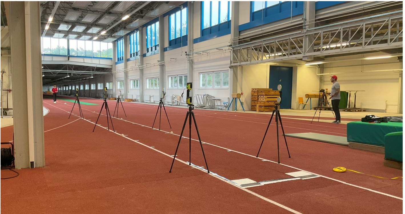
Abb. 8.8 Lichtschrankenbatterie zur Bestimmung der Anlaufgeschwindigkeit im Weitsprung
